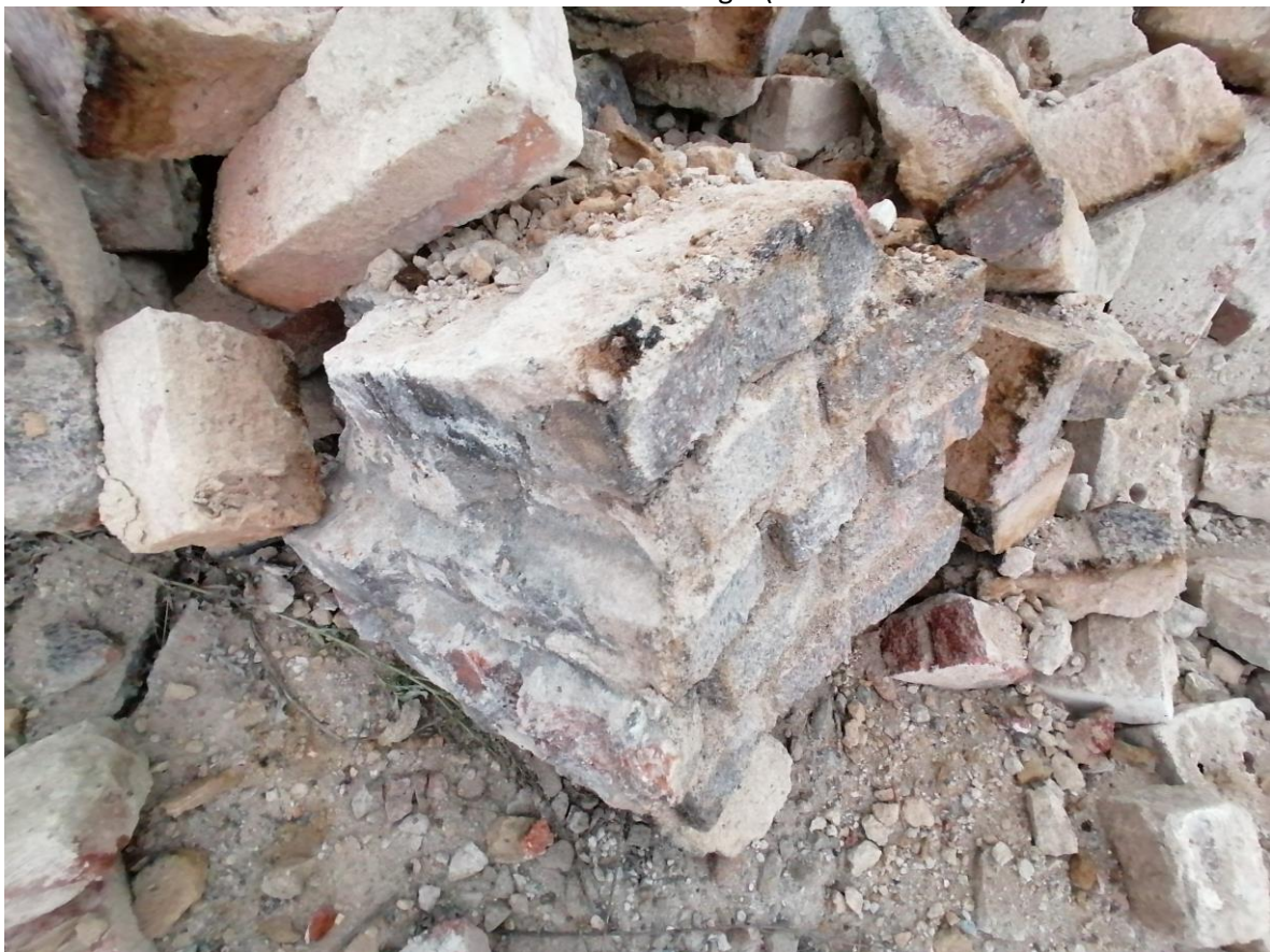
Foto 2: Nahaufnahme der Schornsteinziegel mit dunklen Verfärbungen (Datum: 01.11.2021).
