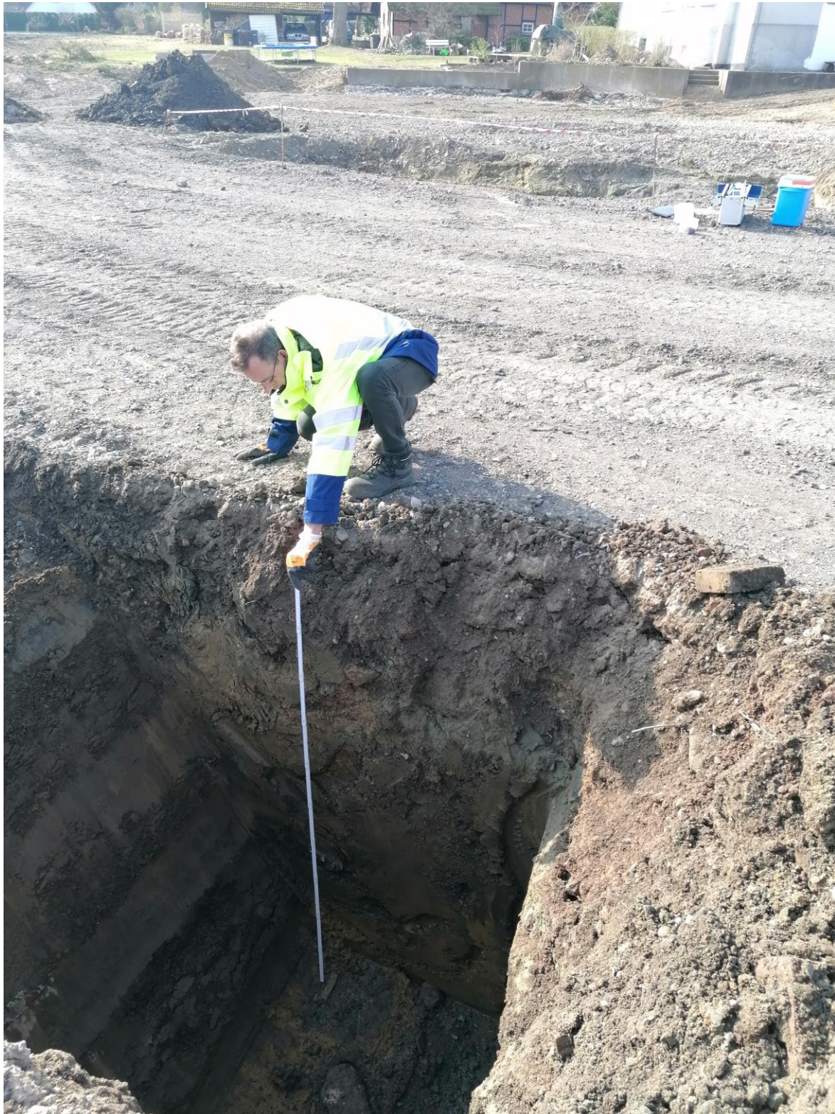
Foto 29: Baggerschurf BS3 zur nördlichen Abgrenzung des MKW-Schadens (Datum: 21.03.2022).
