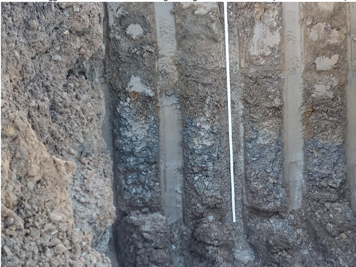
Foto 28: Nahaufnahme des Baggerschurfs BS1 mit der Tonsteinschicht (Datum: 11.01.2022).
