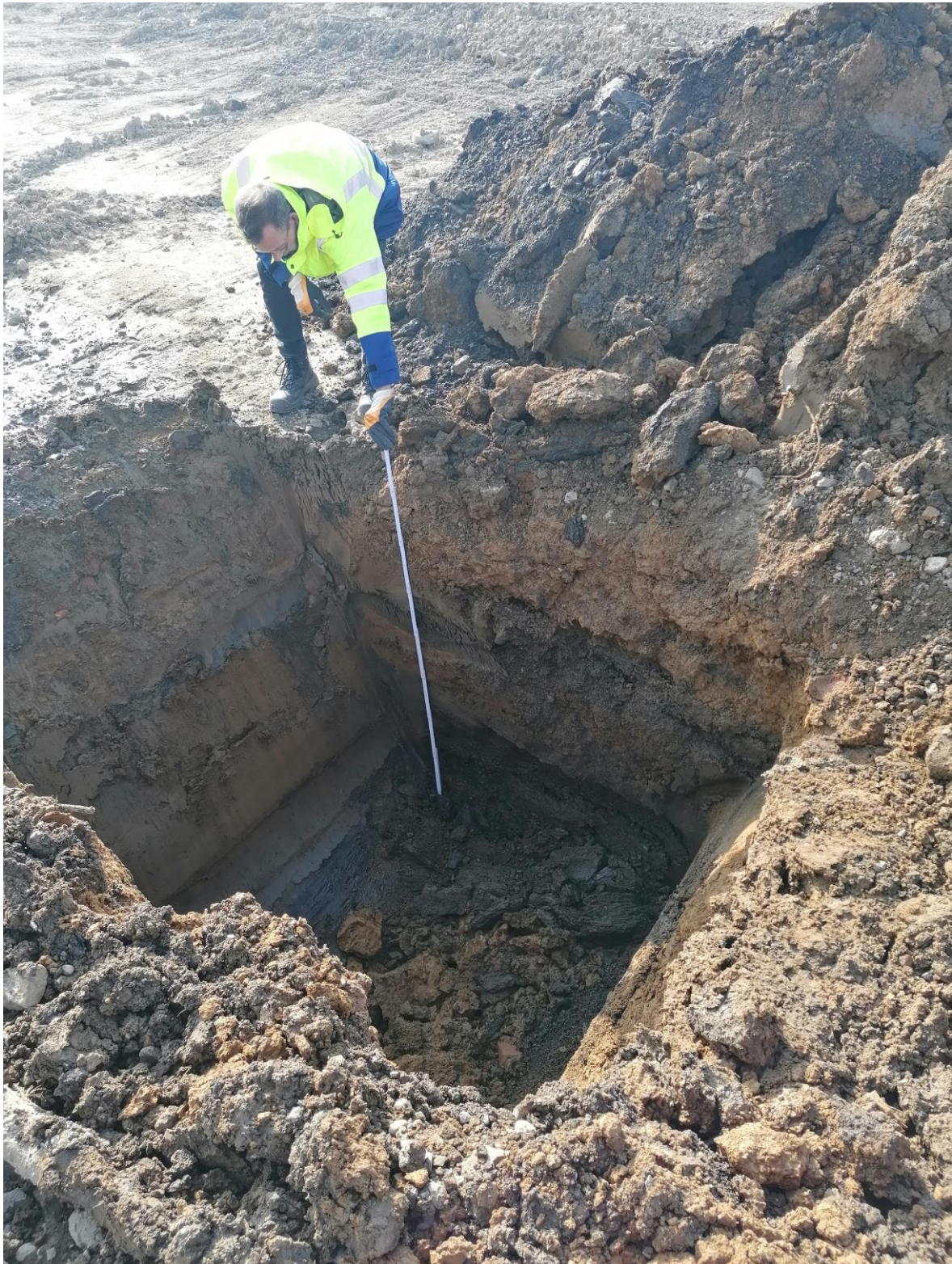
Foto 30: Baggerschurf BS5 zur nördlichen Abgrenzung des MKW-Schadens (Datum: 21.03.2022).
