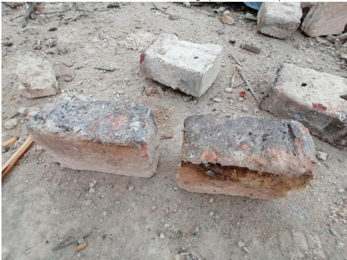
Foto 4: Nahaufnahme der Schornsteinziegel mit dunklen Verfärbungen (Datum: 01.11.2021).
